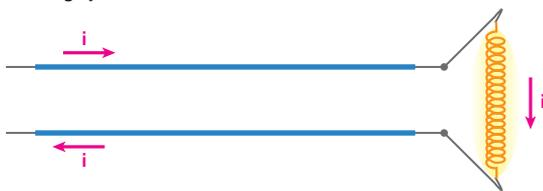
$Pot = Ri^2$ : como a resistência elétrica dos fios de ligação é desprezível em comparação com a do filamento, a potência dissipada nos fios também é desprezível em comparação com a dissipada no filamento.
